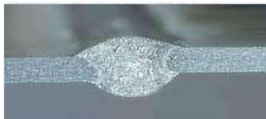
شکل ۳- اتصال جوش شیاری بدون استفاده از پشت بند ورق AlMg_3 با ضخامت ۰/۳ میلی متر
